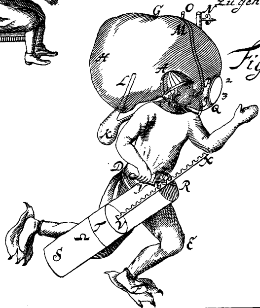
Borelli Maschine unter Wasser zu gehen
